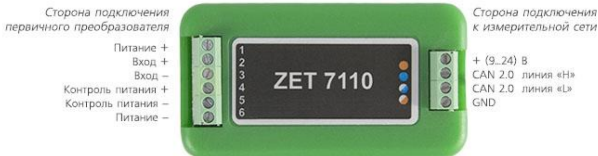
Рис. 2.4 Обозначении контактов ZET 7110, ZET 7111 в лабораторном исполнении
