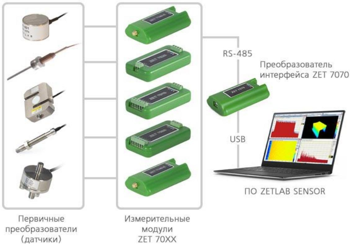
Рис. 2.4 Схема подключения
