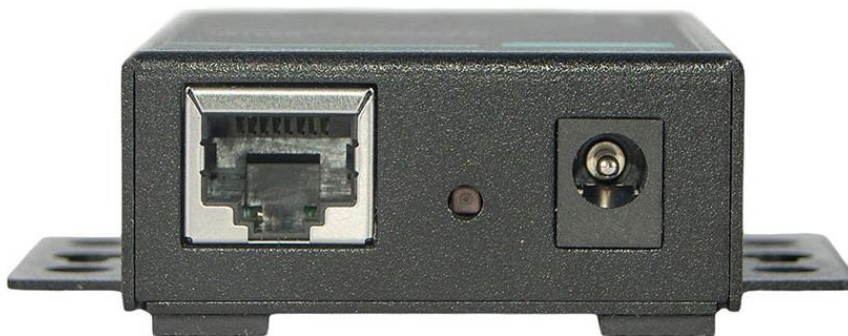
Рис. 2.4 Разъемы для подключения ZET7076 к компьютеру и источнику питания
