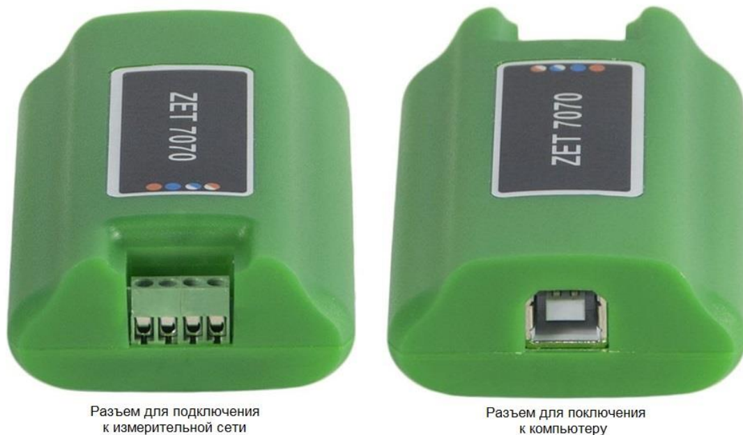
Рис. 2.3 Назначение разъемов преобразователя интерфейса ZET 7070
