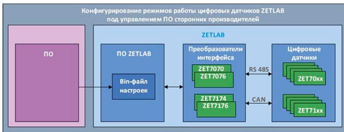
Рисунок 63. Схема взаимодействия при конфигурировании цифровых датчиков
