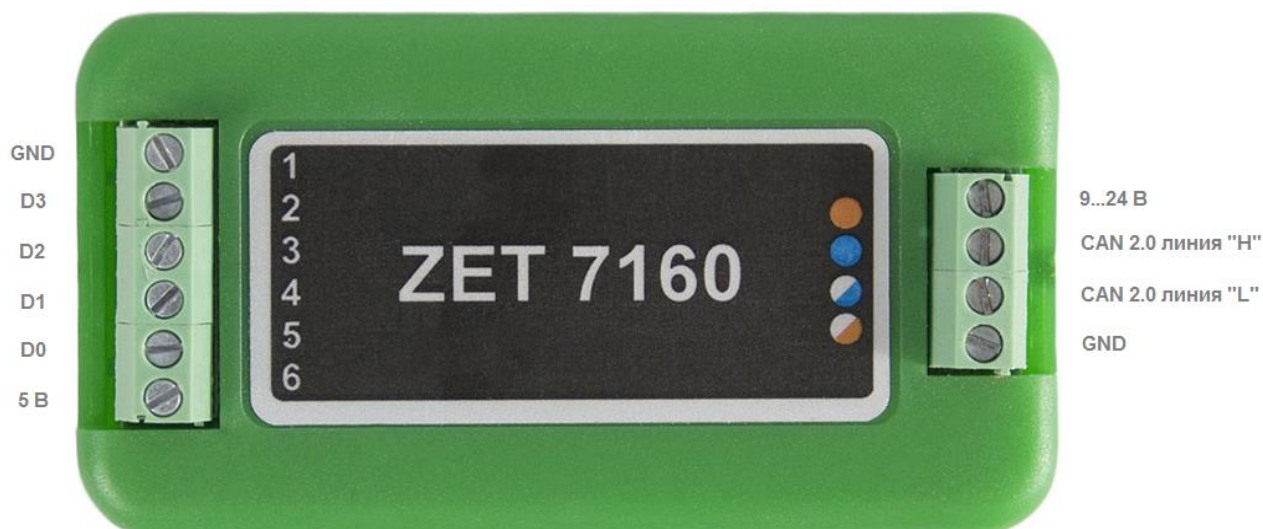
Рис. 2.4 Обозначения клемм ZET 7160 в лабораторном исполнении
