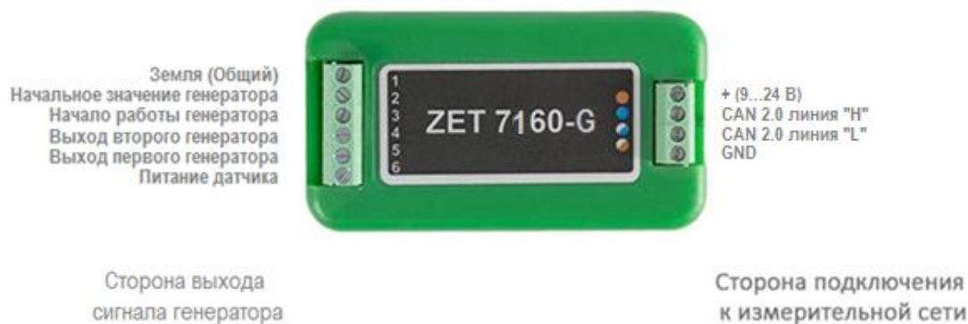
Рис. 2.4 Обозначения клемм ZET 7160-G в лабораторном исполнении
