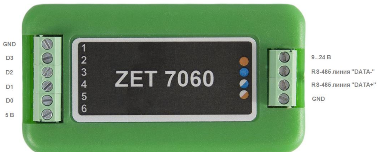
Рис. 2.3 Обозначение клемм ZET 7060 в лабораторном исполнении
