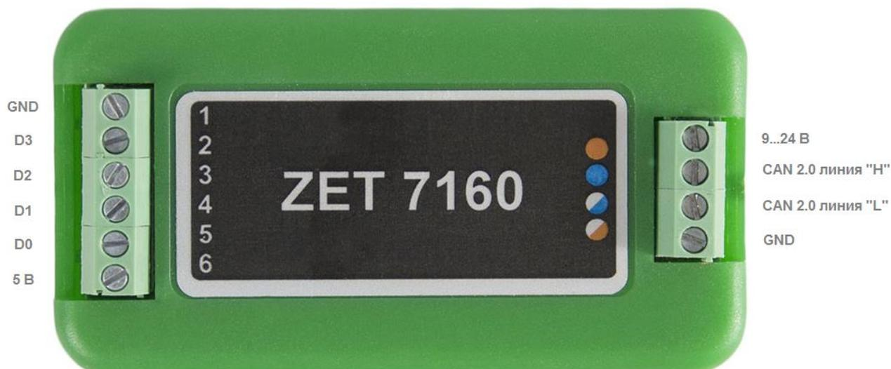
Рис. 2.4 Обозначения клемм ZET 7160 в лабораторном исполнении
