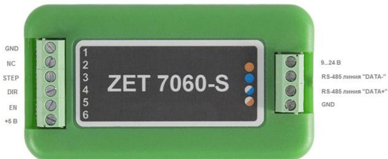
Рис. 2.3 Обозначение клемм ZET 7060-S в лабораторном исполнении
