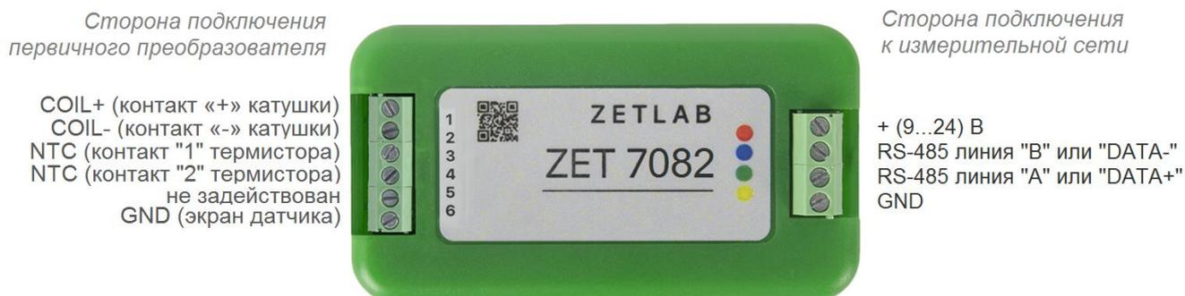
Рис. 2.3 Обозначение клемм ZET 7082 в лабораторном исполнении
