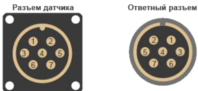
Рис. 2.6 Расположение контактов разъема аналогового интерфейса инклинометра
