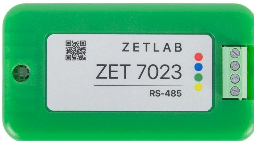
Рис. 2.1 Внешний вид метеодатчика ZET 7023 в лабораторном исполнении
