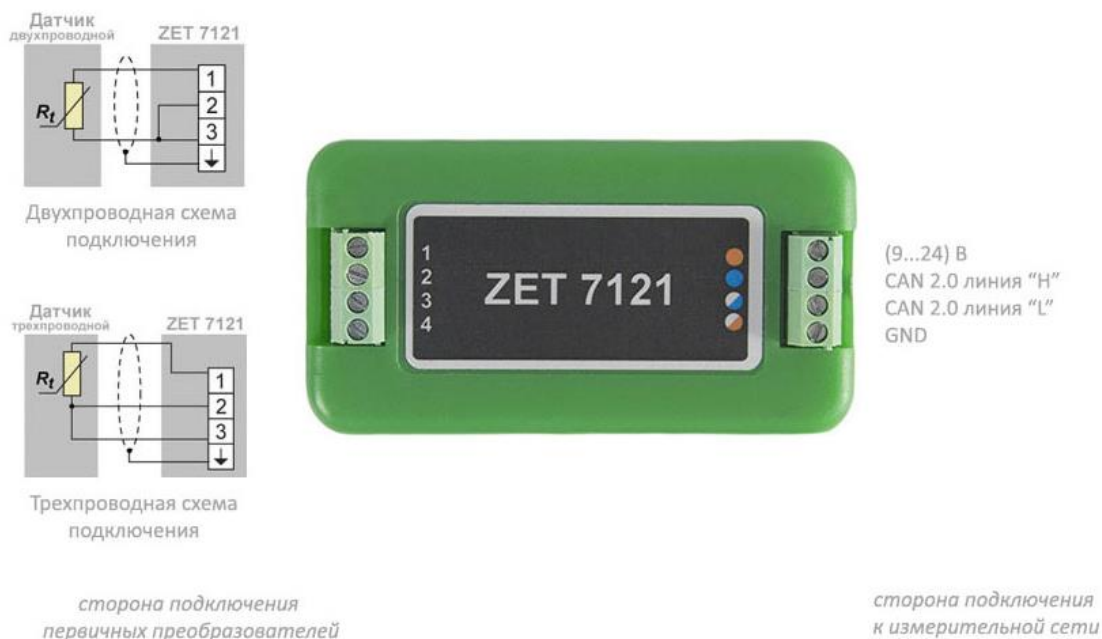
Рис. 2.4 Обозначение контактов ZET 7121 в лабораторном исполнении
