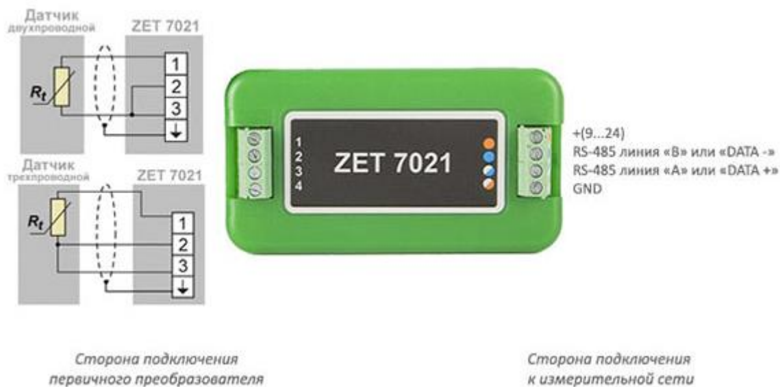
Рис. 2.3 Обозначение контактов ZET 7021 в лабораторном исполнении
