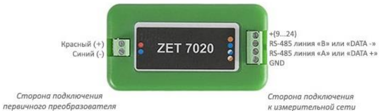
Рис. 2.3 Обозначение контактов ZET7020 в лабораторном исполнении
