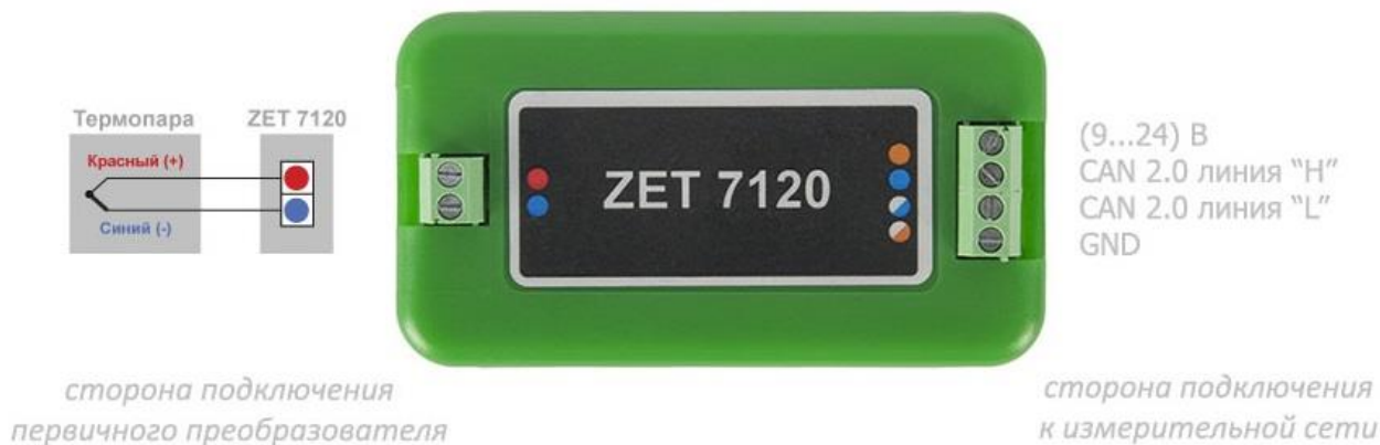
Рис. 2.4 Обозначения контактов ZET7120 в лабораторном исполнении
