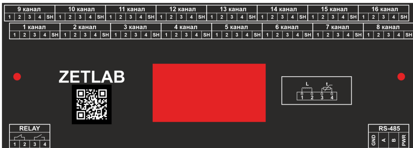
Рис. 2.3 Маркировка клемм ZET 7082-16
