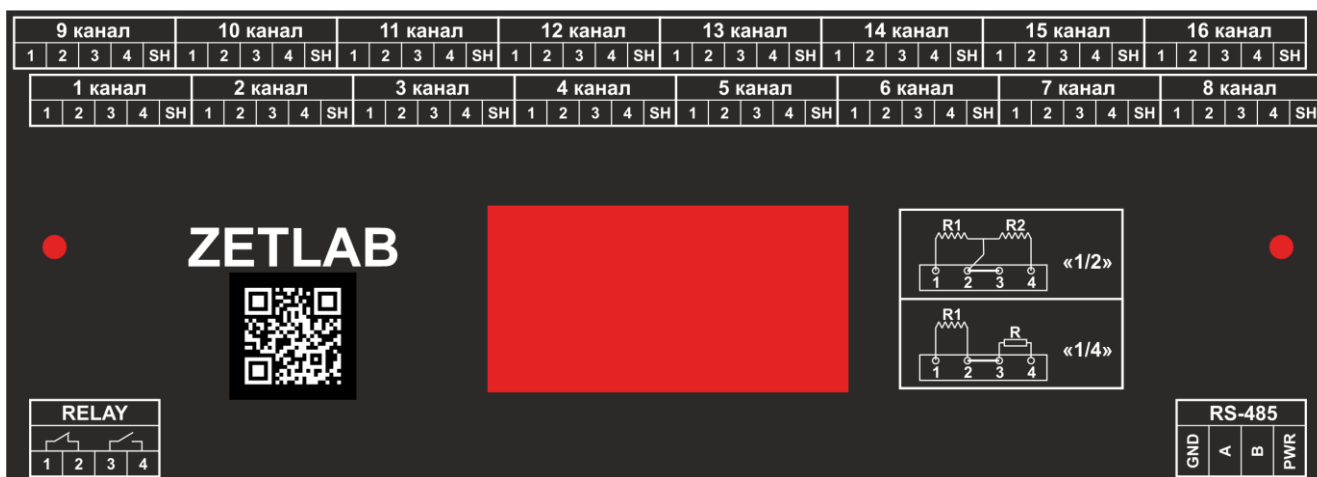
Рис. 2.3 Маркировка клемм ZET 7010-16
