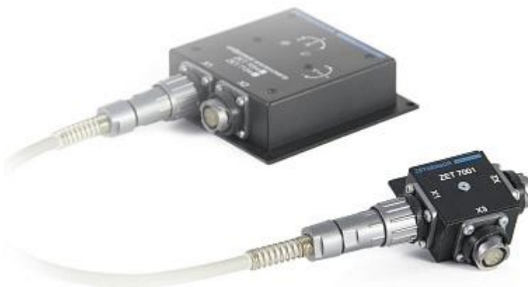
Рис. 3.2 Контроль состояния измерительной линии
