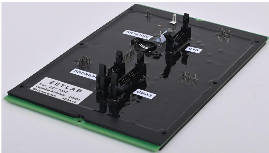
*Рис. 1.2 Внешний вид сейсмодатчика ZET 7057 в OEM исполнении*
