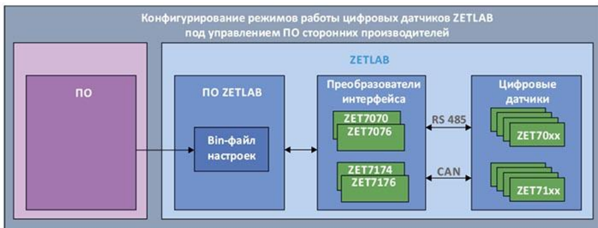
Рисунок 16. Чтение информации с цифровых датчиков ZETLAB при использовании ПО сторонних производителей
