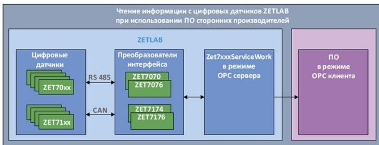
Рисунок 17. Чтение информации с цифровых датчиков ZETLAB при использовании контроллеров и ПО сторонних производителей
