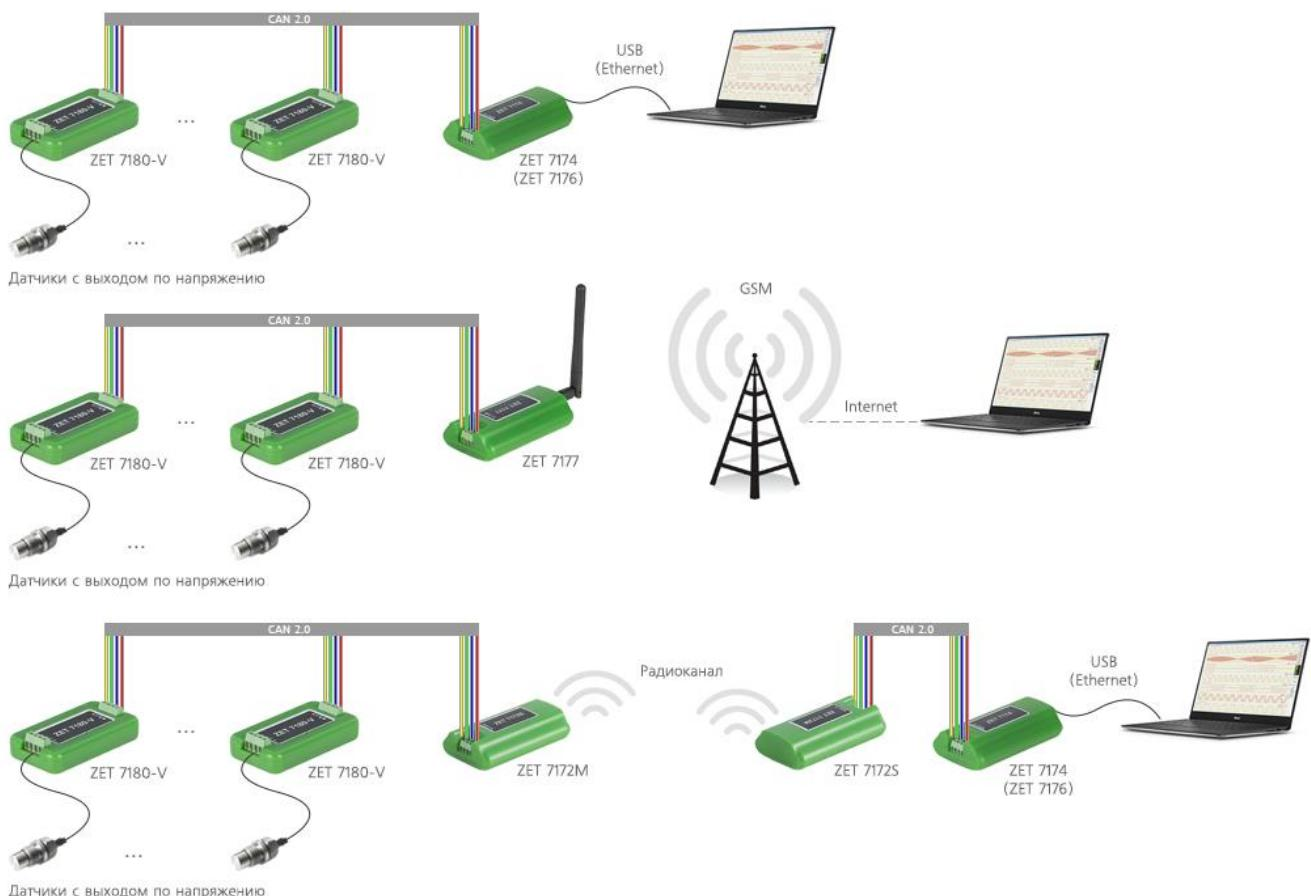
Рис. 2.6 Схема подключения
