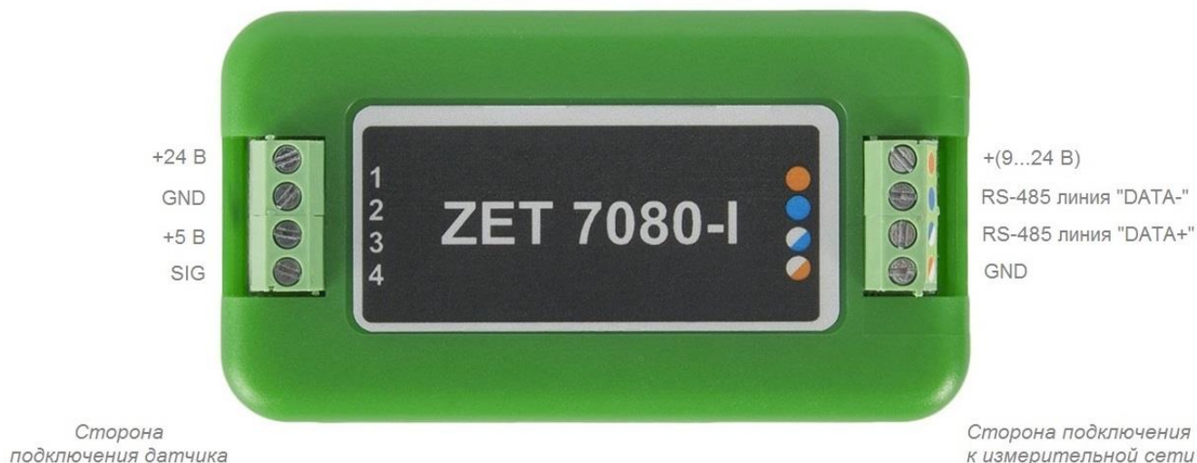
Рис. 2.3 Обозначение разъемов ZET 7080-I в лабораторном исполнении
