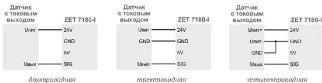
Рис. 2.5 Схемы подключения датчиков с токовым выходом
