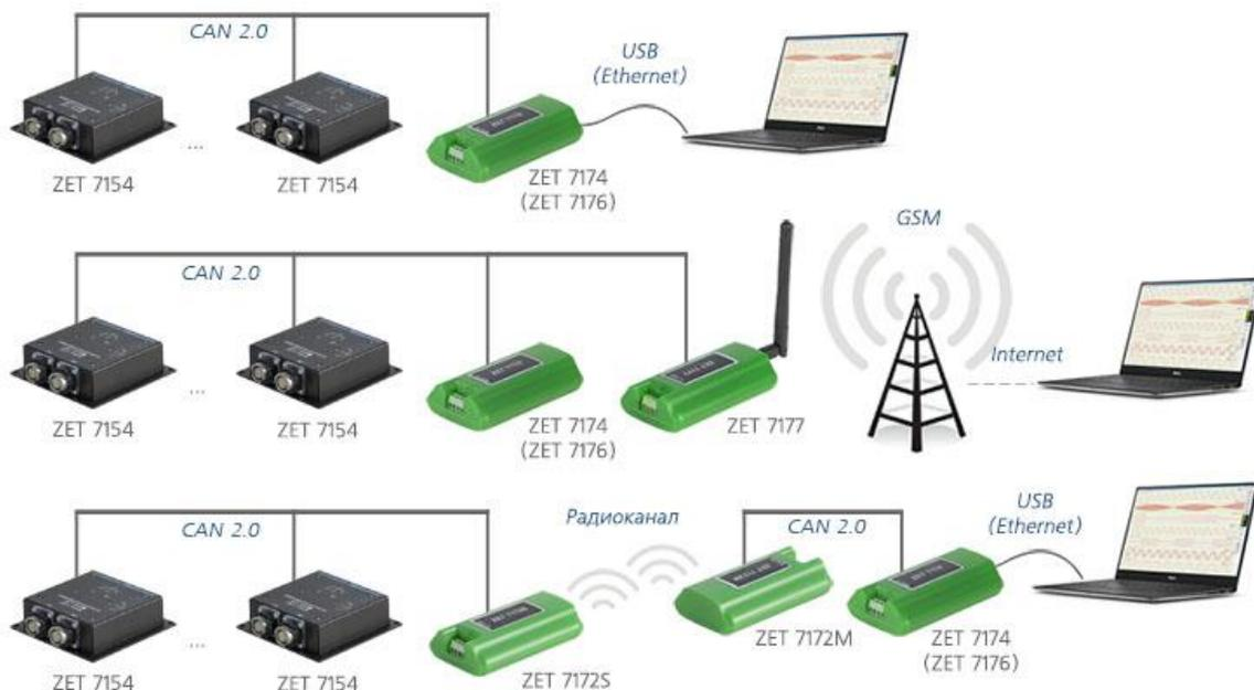
Рис. 2.7 Варианты построения измерительных линий с интерфейсом CAN
