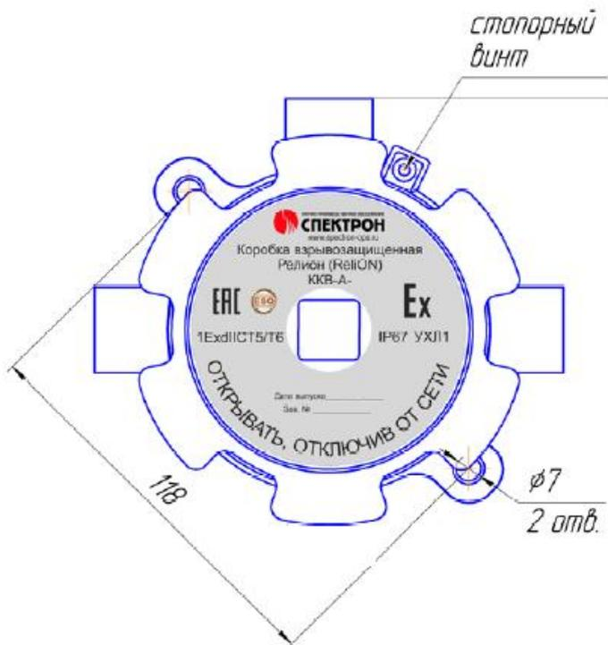
*Рис. 2.4 Присоединительные размеры инклинометра в взрывозащищенном исполнении*
