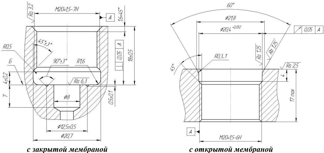
Рис. 3.1 Разметка посадочных мест для монтажа датчиков давления
