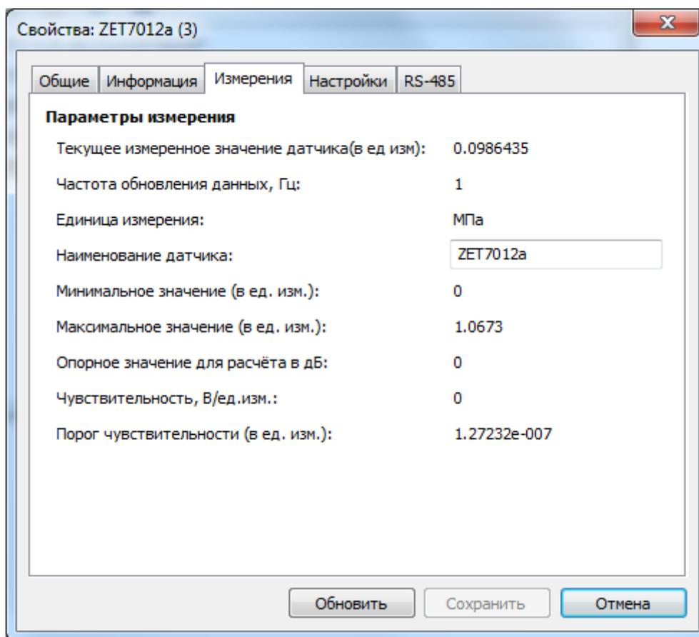
Рис. 5.1 Вкладка «Измерения»
