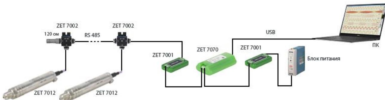
Рис. 2.5 Схема подключения
