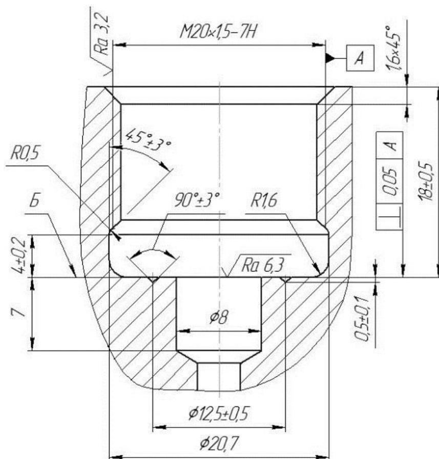
Рис. 3.1 Разметка посадочного места для монтажа датчика давления
