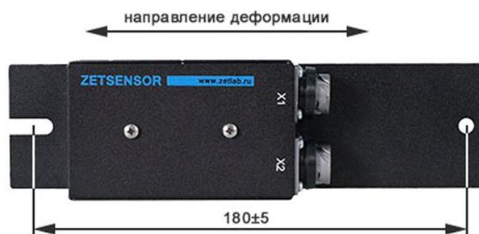
Рис. 5.2 Направление деформации и базовое расстояние
