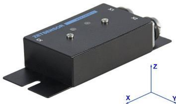
Рис. 2.3 Направление осей X, Y, Z
