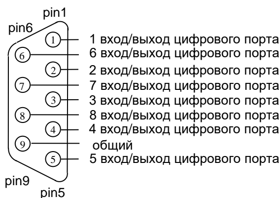
Рисунок 8.2 - Назначение выводов разъема DB-9
