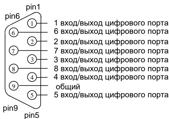
Рисунок 8.2 - Назначение выводов разъема DB-9
