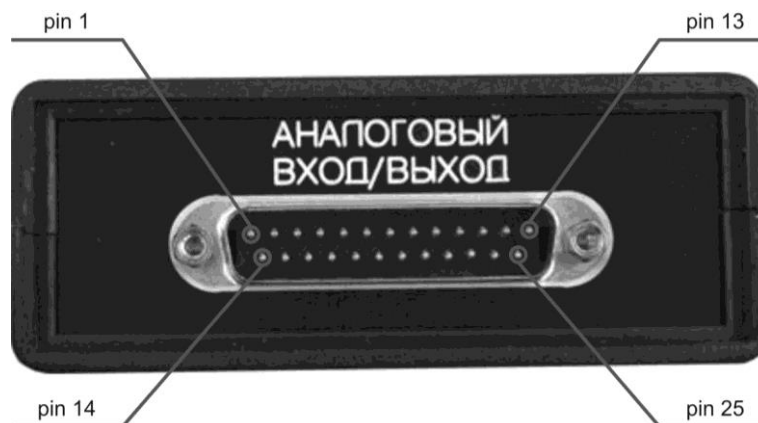
Рисунок 8.3 – Общий вид модуля АЦЦАП ZET 210 со стороны передней панели
