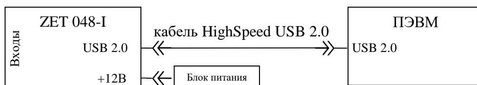
Рис. 1.2 Подключение регистратора ZET 048-I к ПЭВМ по интерфейсу USB 2.0
