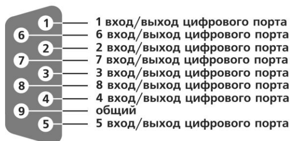
Рисунок А.1 - Назначение выводов разъема DB-9 (ZET 048-I)
