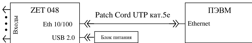
Рисунок 1.5 – подключение регистратора ZET 048-I к ПЭВМ по интерфейсу Ethernet с питанием от внешнего источника
