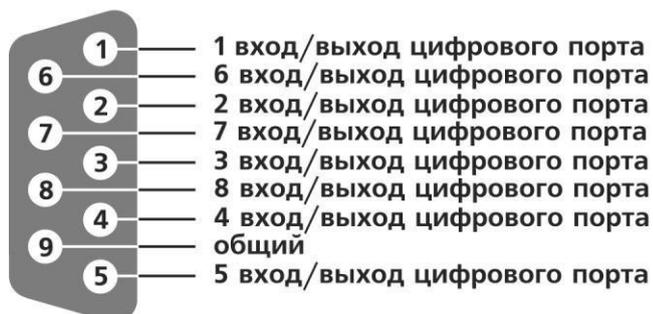
Imagen A.1 – Funciones de los terminales con conectores DB-9 (ZET 048-I)
