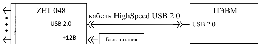
Рисунок 1.4 – подключение регистратора ZET 048-E к ПЭВМ по интерфейсу USB 2.0
