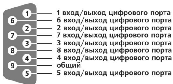
Рисунок А.1 - Назначение выводов разъема цифровой порт DB-9
