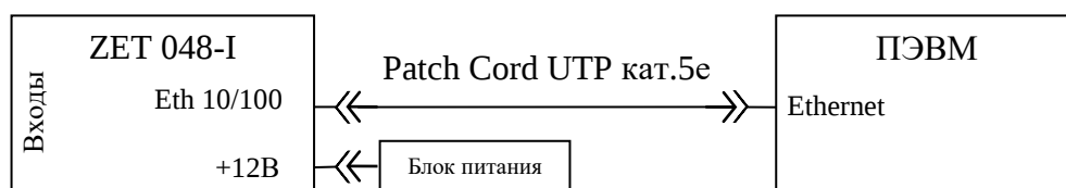
Рис. 1.3 Подключение регистратора ZET 048-I к ПЭВМ по интерфейсу Ethernet
