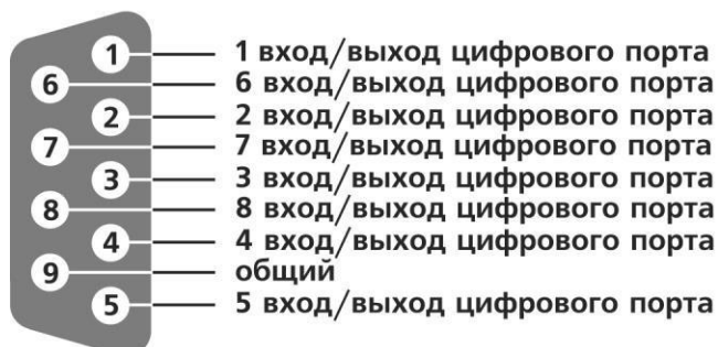
Imagen A.1 – Funciones de los terminales con conectores DB-9 (ZET 048-I)
