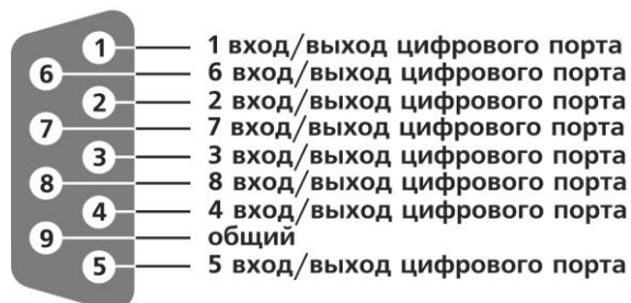
Рисунок А.1 - Назначение выводов разъема DB-9 (ZET 048-I)
