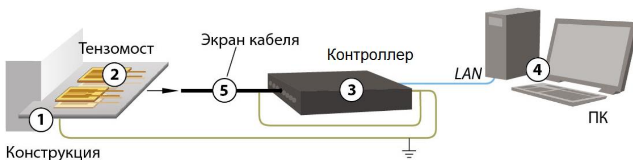
Рис. 2.1 Схема заземления при работе с контроллера с тензорезисторами
