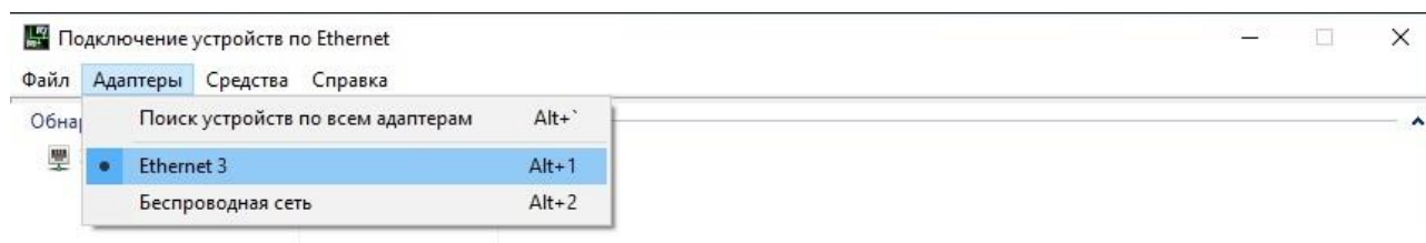
Рис. 3.2 Выбор сетевого адаптера контроллера
