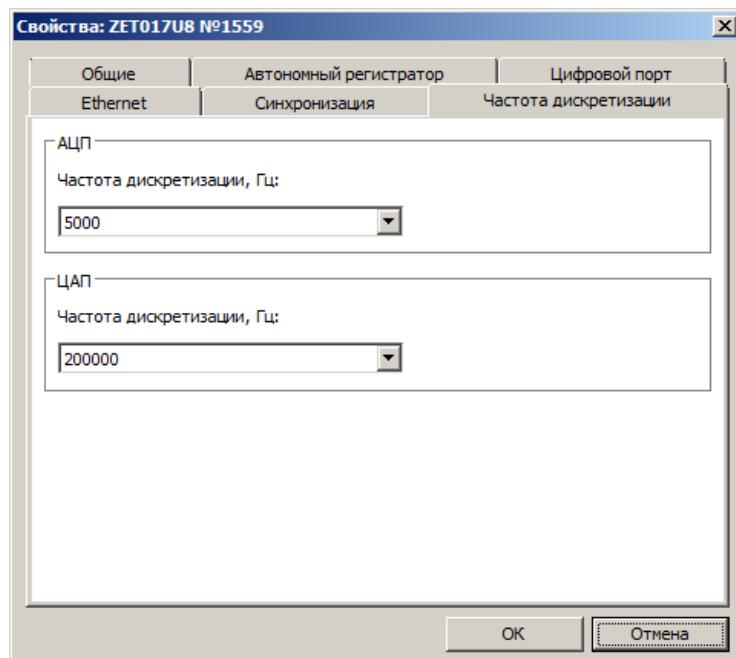
*Рис. 3.16 Вкладка Частота дискретизации окна Свойства*
