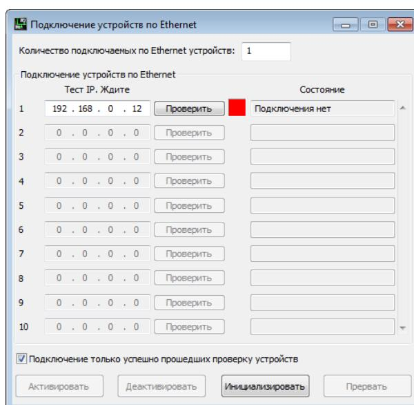
Рис. 3.13 Окно программы «Подключение устройств по Ethernet»
