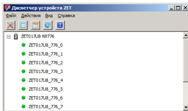
*Рис. 3.19 Окно Диспетчера устройств с раскрытым списком измерительных каналов анализатора спектра ZET017U8*
