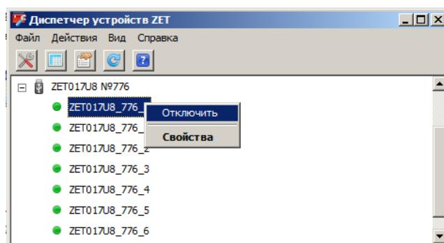
*Рис. 3.20 Окно Диспетчера устройств с выпадающим окном по выделенному измерительному каналу*
