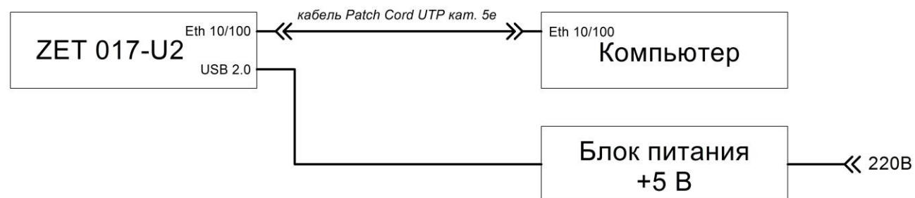
Рис. 3.9 Схема подключения ZET 017-U2 по Ethernet
