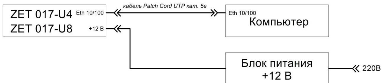
Рис. 3.12 Схема подключения ZET 017-U4/U8 по Ethernet
