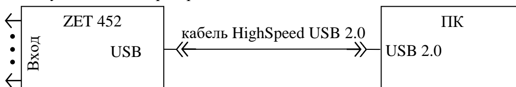
Рисунок 3 – подключение устройства к ПК по кабелю USB 2.0
