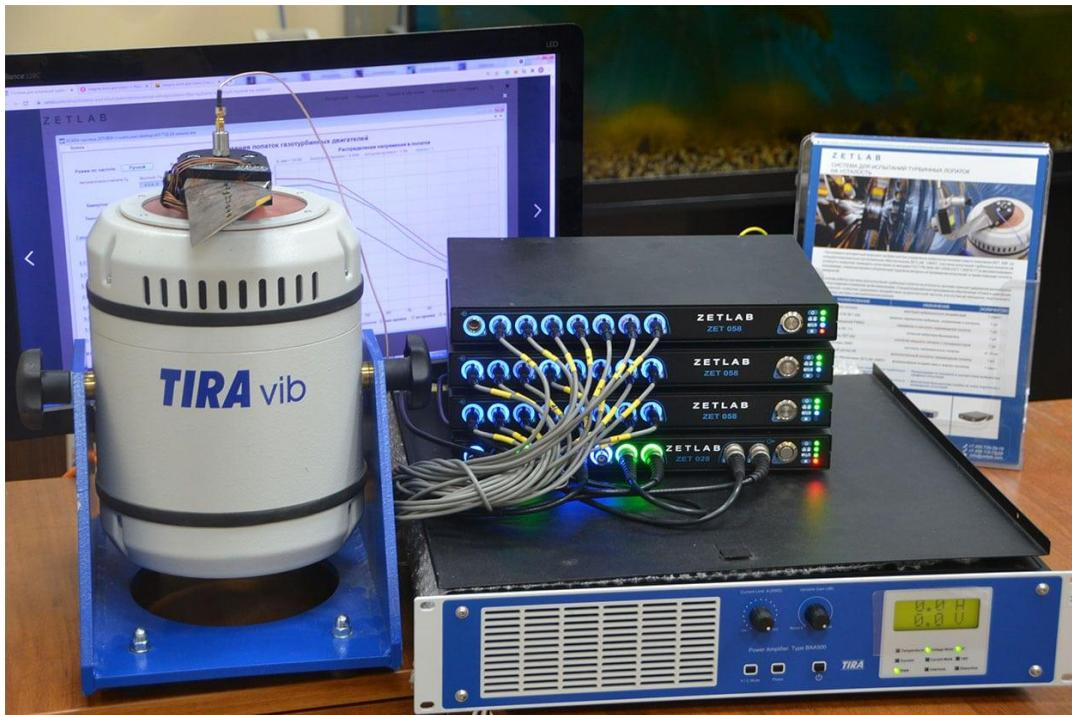
*Рис. 18.8 Комплект оборудования для снятия распределения напряжений лопатки*
