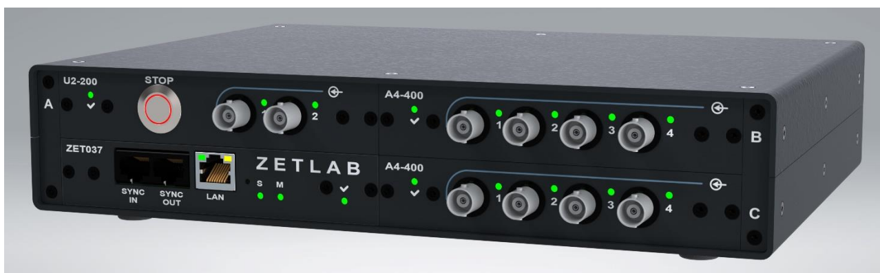
Рис. 3.1 Внешний вид блока регистрации в исполнении 3 слота
