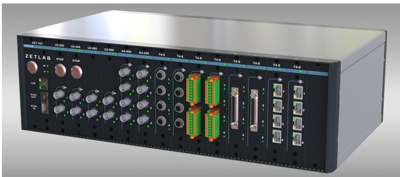
Рис. 3.2 Внешний вид блока регистрации в исполнении 14 слотов
