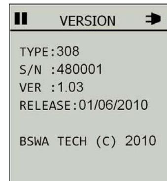
Окно **Version** содержит информацию о приборе: тип и серийный номер прибора, версию и дату программного обеспечения.
