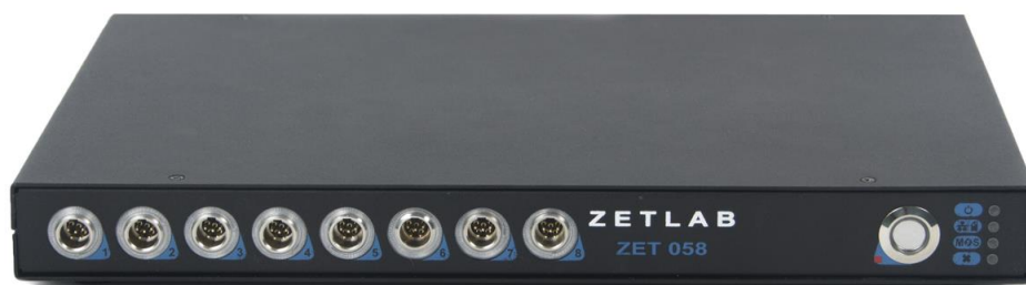
Рис. 1.1 Внешний вид восьмиканального контроллера ZET 058
