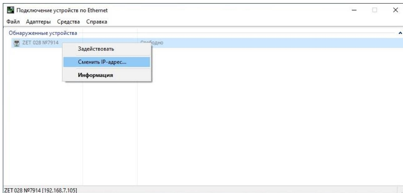
Рис. 3.4 Вызов функции смены IP-адреса контроллера
