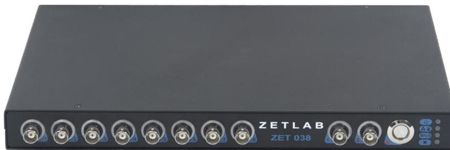
*Рис. 1.3 Внешний вид восьмиканальных контроллеров ZET 038*
