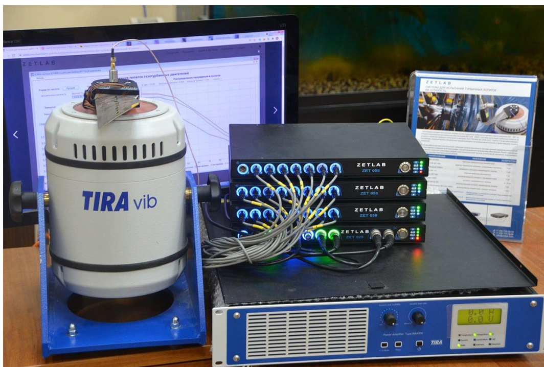
Рис. 19.8 Комплект оборудования для снятия распределения напряжений лопатки
