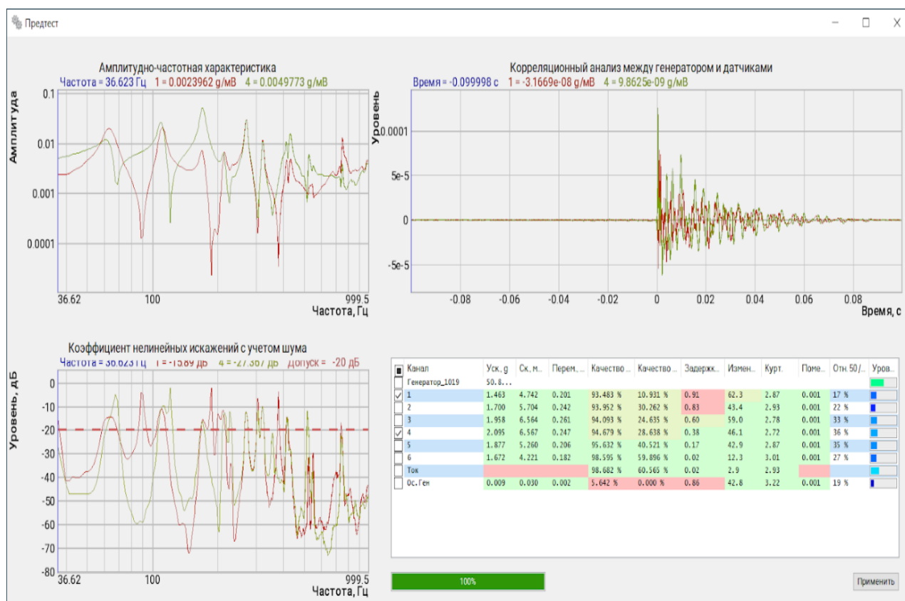
Рис. 8.16 Результаты предтеста по двум датчикам, установленным в неудачных местах
