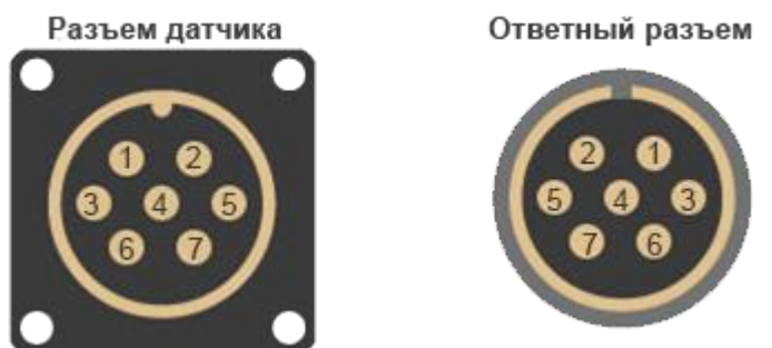
Рис. 2.6 Расположение контактов разъема аналогового интерфейса инклинометра
